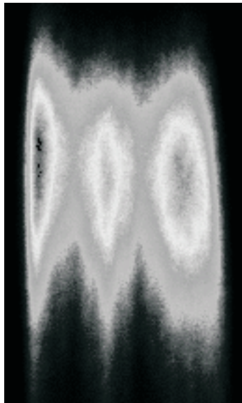
Obrázek 4.1: Obraz zaznamenaný streak kamerou (výřez)
