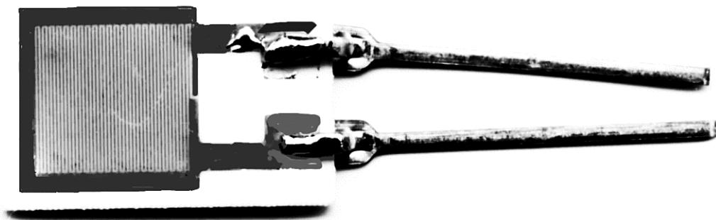
Obrázek 2.4: Systém povrchových elektrod s připojenými kontakty.
